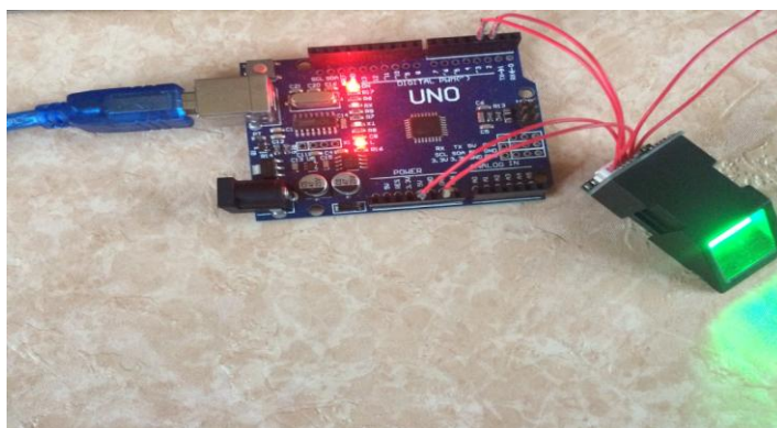
Рис. 1. Схема пристрою ідентифікації за відбитками пальців
